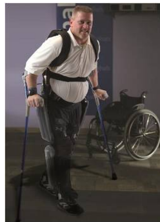
脊髄損傷者の歩行支援ロボット Rewalk (安川電気)
