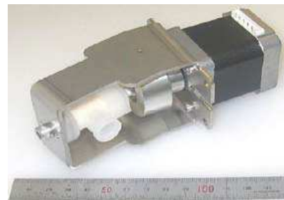
改質水ポンプ
