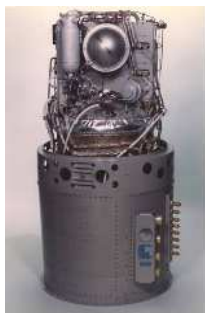
アポロ宇宙船の 1.5kW燃料電池 出典: UTC Power社HP
