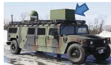
指令管理戦闘車両の補助電源 出典: Journal of Power Sources 136 (2004)
