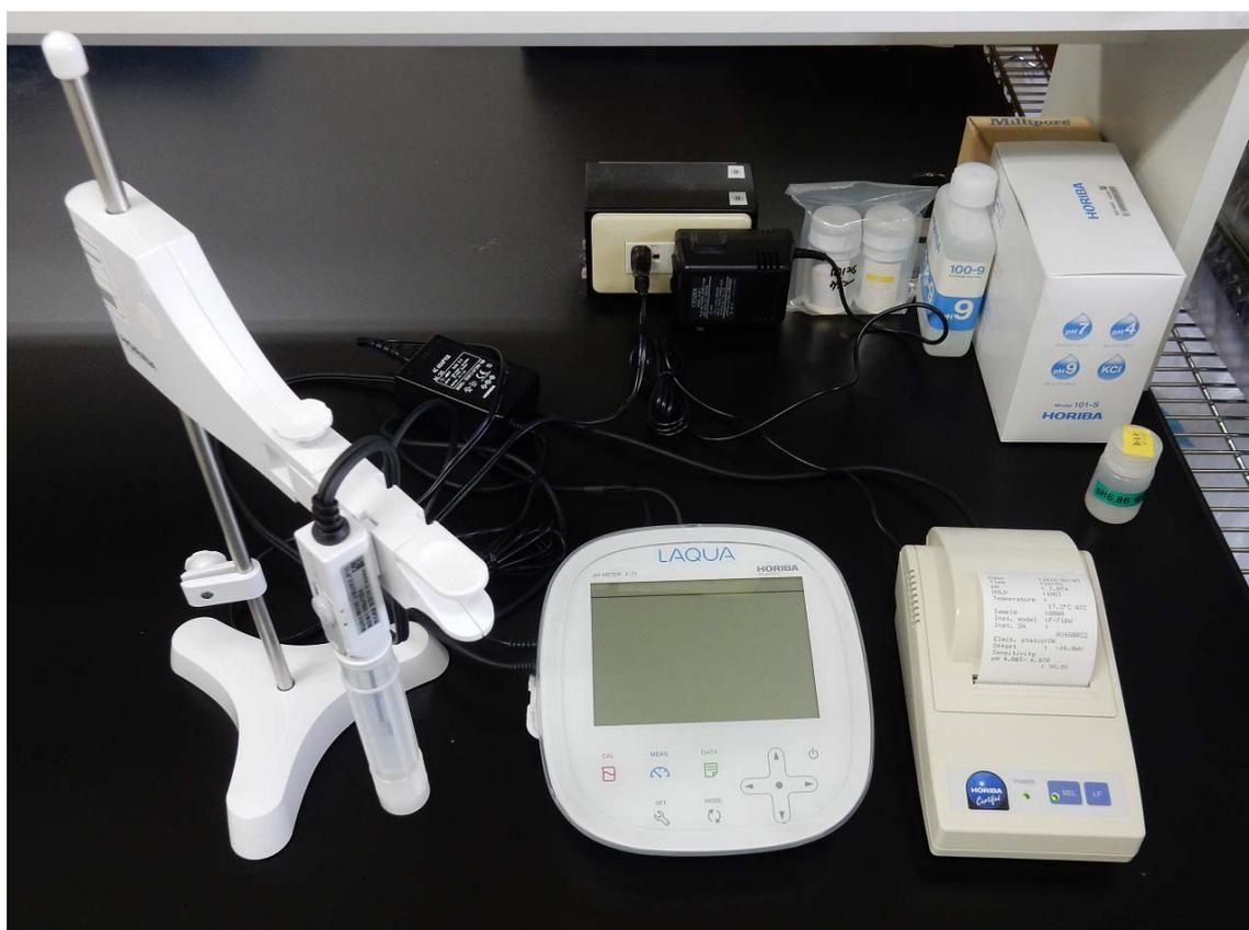
雨水のpHを測定するために2016年に更新した卓上pH計。
