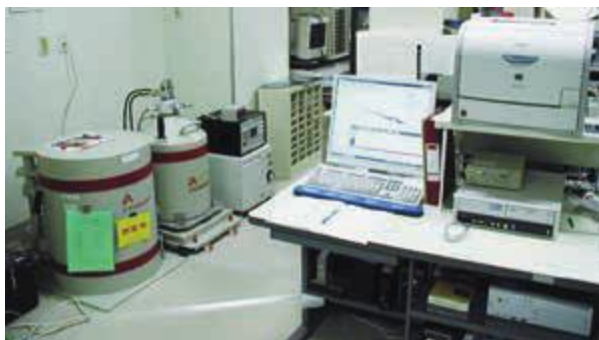
図1 Ge半導体検出器付きγ線スペクトロメータ
