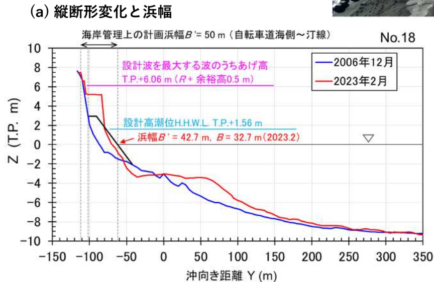
図1.2 浜幅検証断面（海岸中央部No.18）の縦断形変化と浜幅
