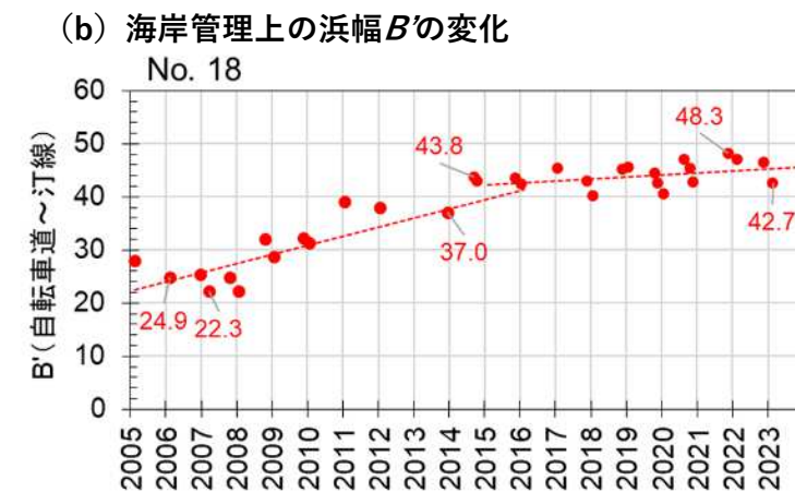
図1.2 浜幅検証断面（海岸中央部No.18）の縦断形変化と浜幅
