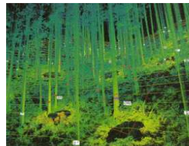
地上レーザ機器により取得する森林の三次元点群データ（イメージ）
