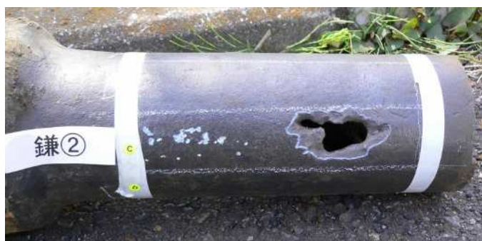
(水道管（1935年布設）の腐食状況)
