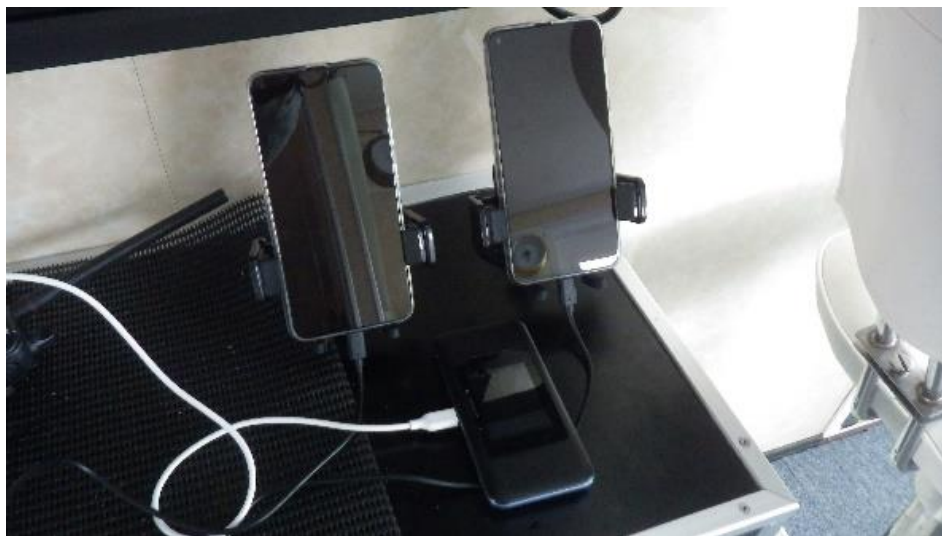
図2 スマートフォンで4項目のデータ収集（1、燃料消費量の計測記録 2、エンジン回転数の計測記録 3、船室内騒音録音 4、GPS を利用した船速計測）
