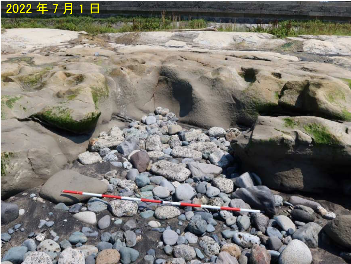
写真-13 大量に堆積した円礫との衝突により侵食が進む軟岩
