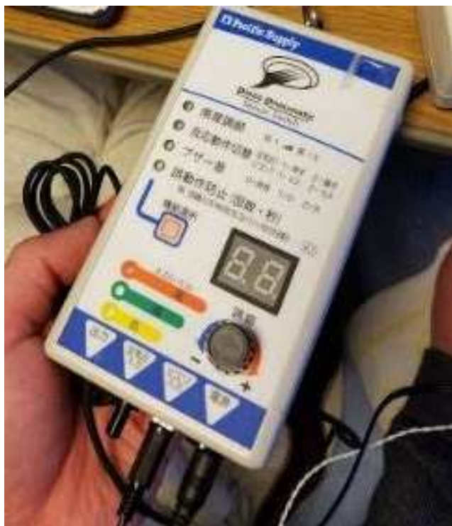
PPSスイッチ アナログ信号をスイッチ操作に変換
