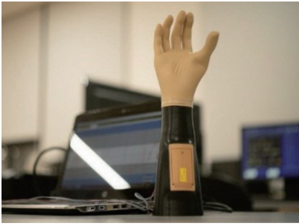
筋電義手は腕の筋肉から発生するわずかな電流に反応し、自分の意思で手の部分を動かすことができます
