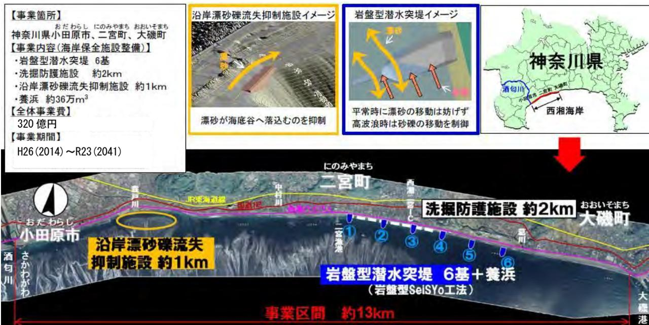
突堤整備後は、養浜や漂砂により施設は埋没した状態となるため、突堤に遮られることなく下流側へ漂砂が移動することが可能となる。
