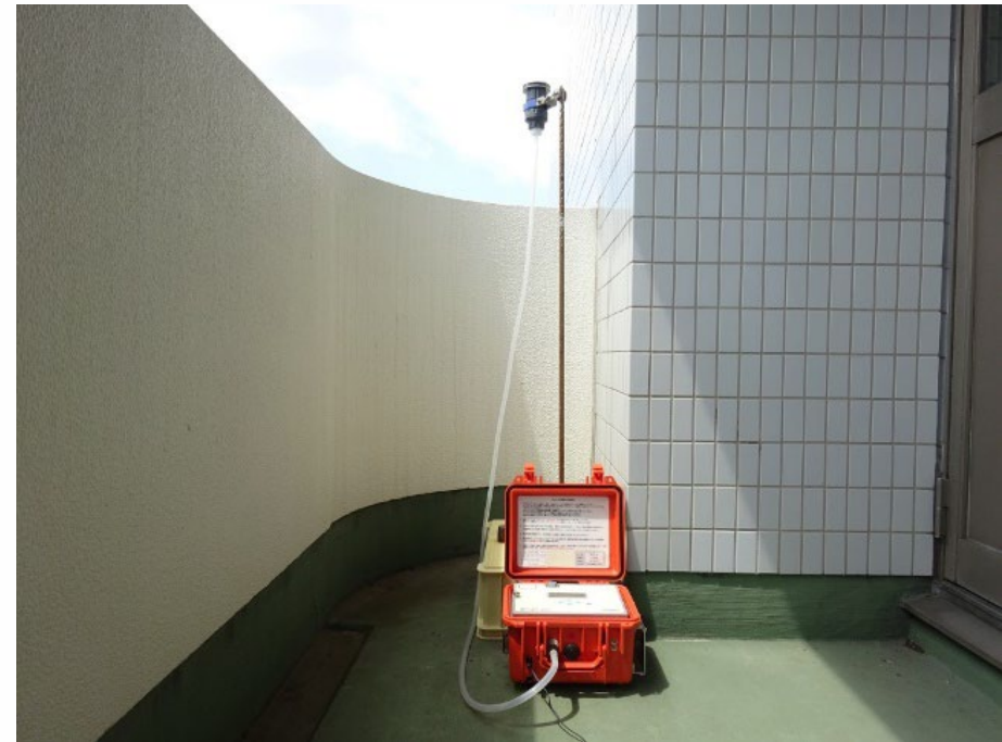
サンプリング（当C2Fベランダ） 5 L/minで24h（10:00-10:00）
