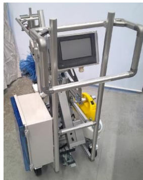
本事業で開発した「半自動小便器清掃ロボット」試作1号機
