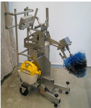
本事業で開発した「半自動小便器清掃ロボット」試作1号機
