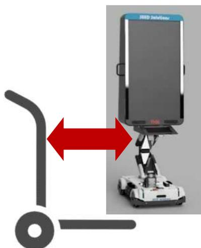
② 準備の際にロボットを走行させる場合は、ロボットから距離を取り、平らな床面を走行する
