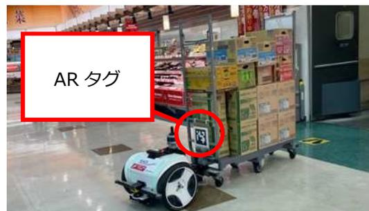
目的地を設定したARタグをカートに取り付けることで、自動で目的地へ搬送、取り外しが可能
