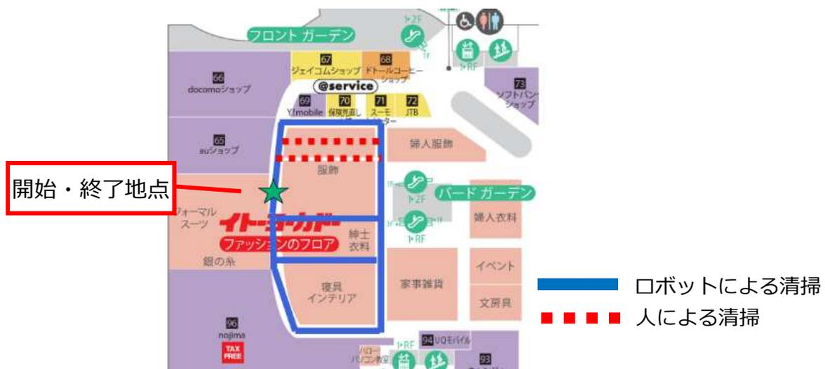
ロボット活用の有無での、清掃時間の違いを調査した結果、清掃エリアの76.11%をロボットによる自律清掃に置き換えることができ、清掃時間を約2割削減できたことが判明しました。
