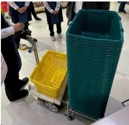
ロボットと買い物カゴ台車を連結することで運搬可能
