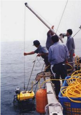
水中カメラロボット（ROV）による調査
