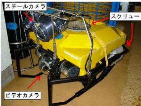
水中カメラロボット（ROV）の各部説明
