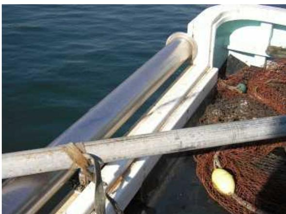
船体後端部は網を海へ出しやすくするために金属製の部品がつけられ、開放的になっています。斜めに見えるこの棒がビームと呼ばれるものです。
