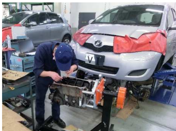
エンジンオーバーホール作業
