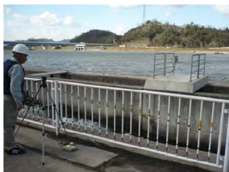
図-6.8 開水路における小水力発電設備の騒音・振動計測事例
