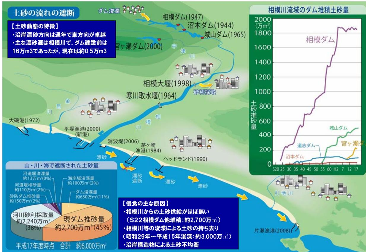
図-25 流域の施設と土砂動態
