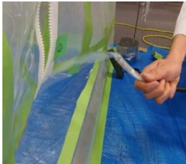
①前室が負圧に保たれていることの 確認方法の例 (スモークテスターによる気流の確認)
