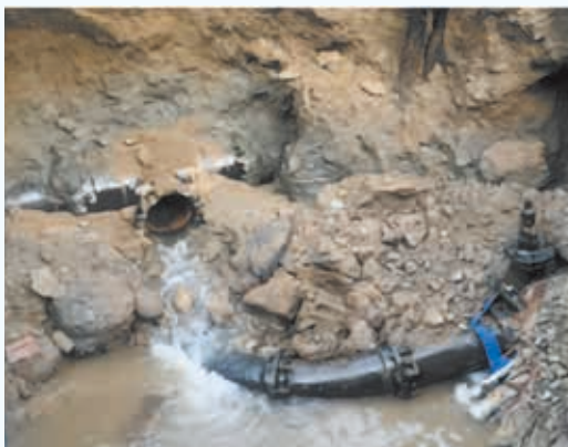
漏水事故現場写真(継ぎ手部の離脱による漏水が発生)
