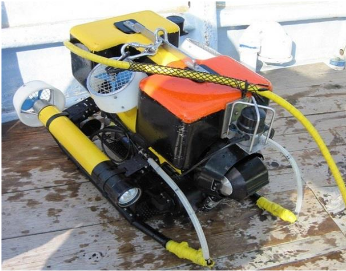
自航式水中カメラ（ROV）の本体
