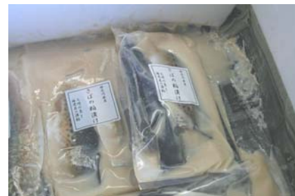
包装部が剥がれ大きく液漏れ
