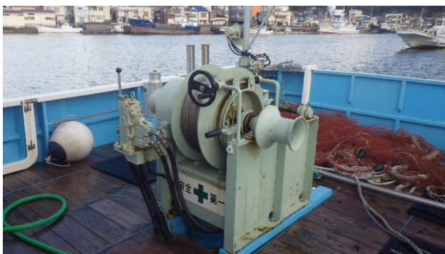
トロールウィンチ （底引き網調査等で ワイヤーを巻き取る油圧機械）
