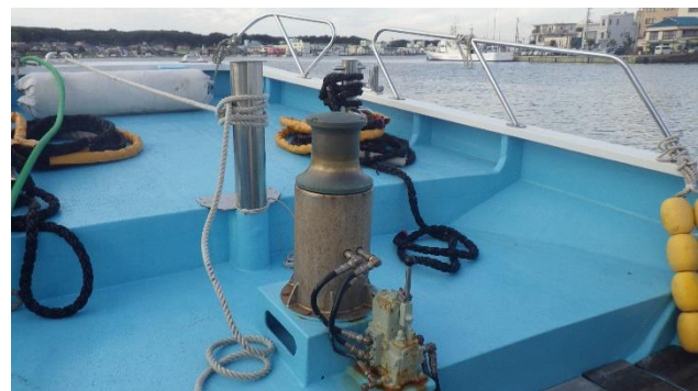
キャプスタン （ロープを巻き取る油圧機械）
