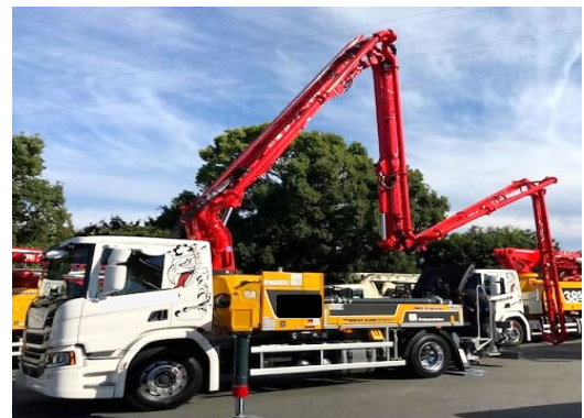
コンクリートポンプ車
