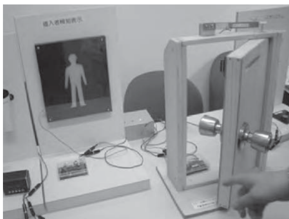
図4 ドアヒンジ発電による無線送信防犯装置
