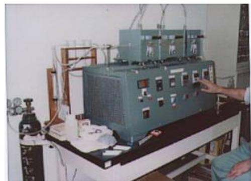
図1 管状加熱炉
