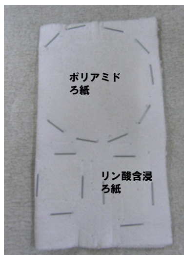
写真 3 N 式パッシブサンプラー
