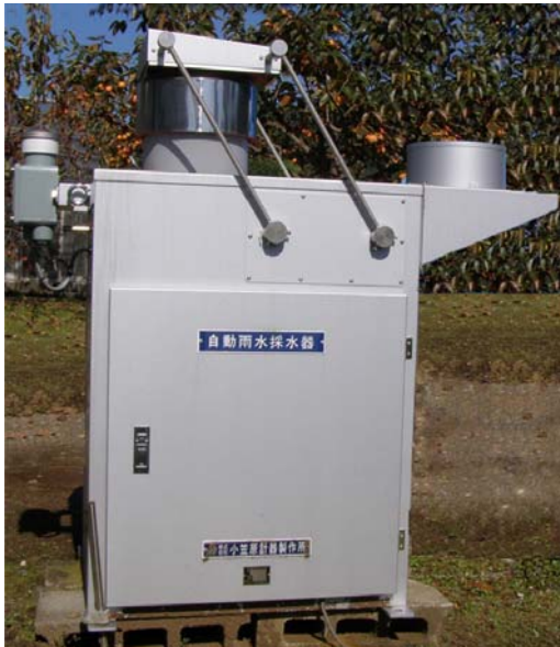
写真1 自動雨水採取装置
