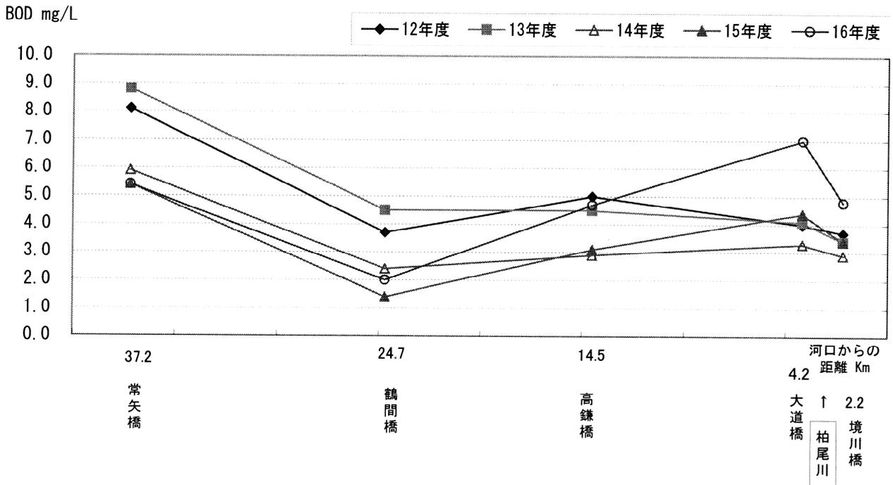
図2-4 相模川におけるBOD縦断変化図
