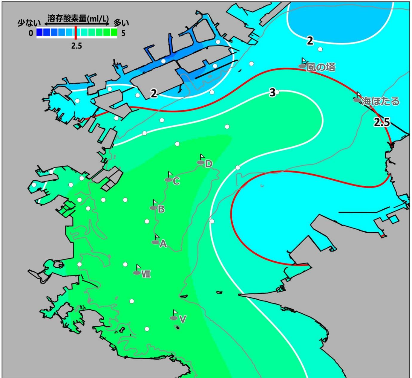
底層の溶存酸素推定分布図 (ml/L)
