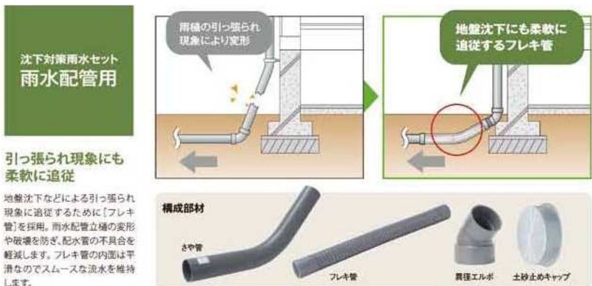
図 3-2-10 排水管の対策イメージ（伸縮継手） （平成 23 年度浦安市液状化対策技術検討調査報告書より）
