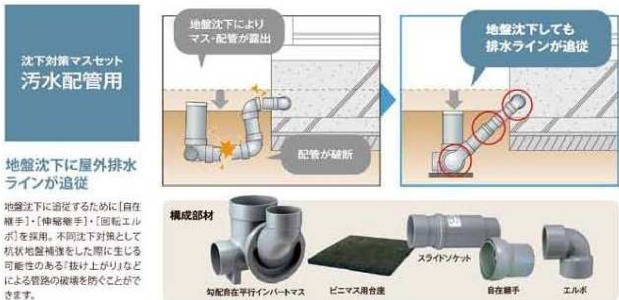
図 3-2-10 排水管の対策イメージ（伸縮継手） （平成 23 年度浦安市液状化対策技術検討調査報告書より）
