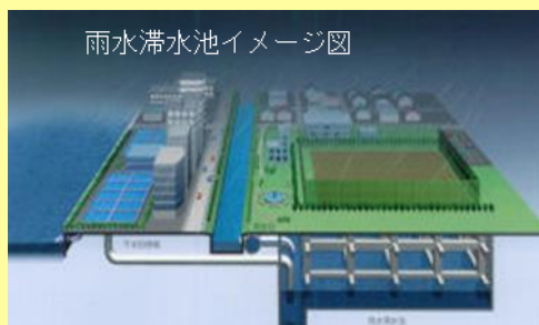
図15 合流式下水道の改善内容
