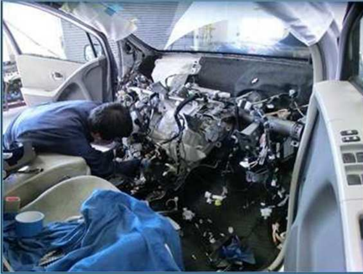
空調装置整備実習
