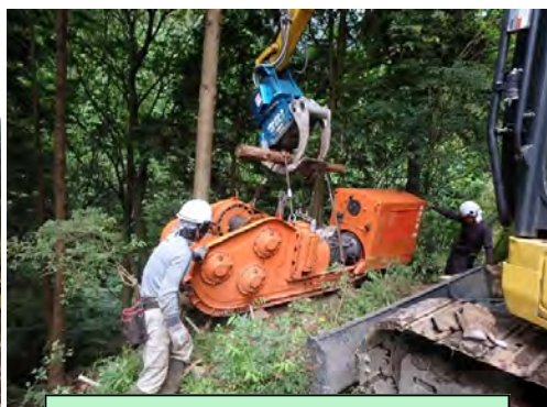
大型集材機による集材作業
