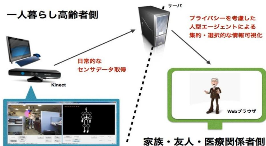
キネクトセンサーにて取得した骨格・運動情報を人型エージェントとしてブラウザ画面に描出する技術を応用した情報提示・共有およびコミュニケーション支援システムを開発中です。
