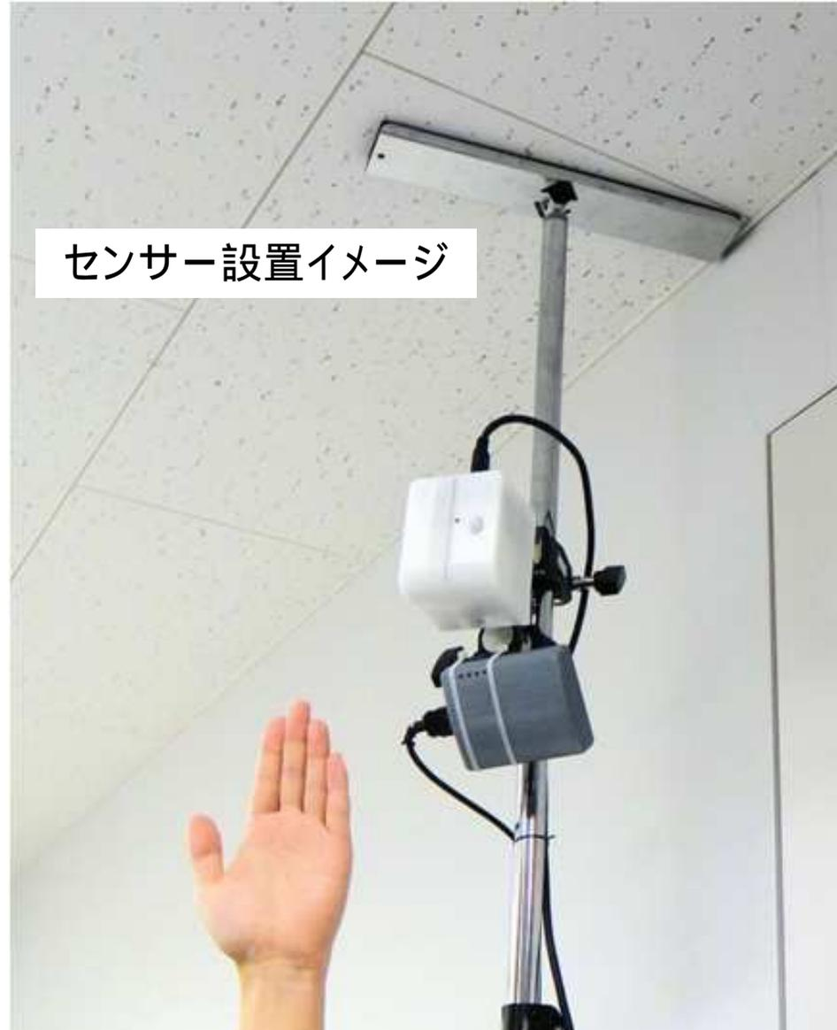
高齢者向け住宅において、モニターの居室に、見守りシステム(写真のセンサーなど)を設置して、3日間、高齢者の生活リズムの変化を計測し、電波センサーを用いた見守り技術の検証を行った。
