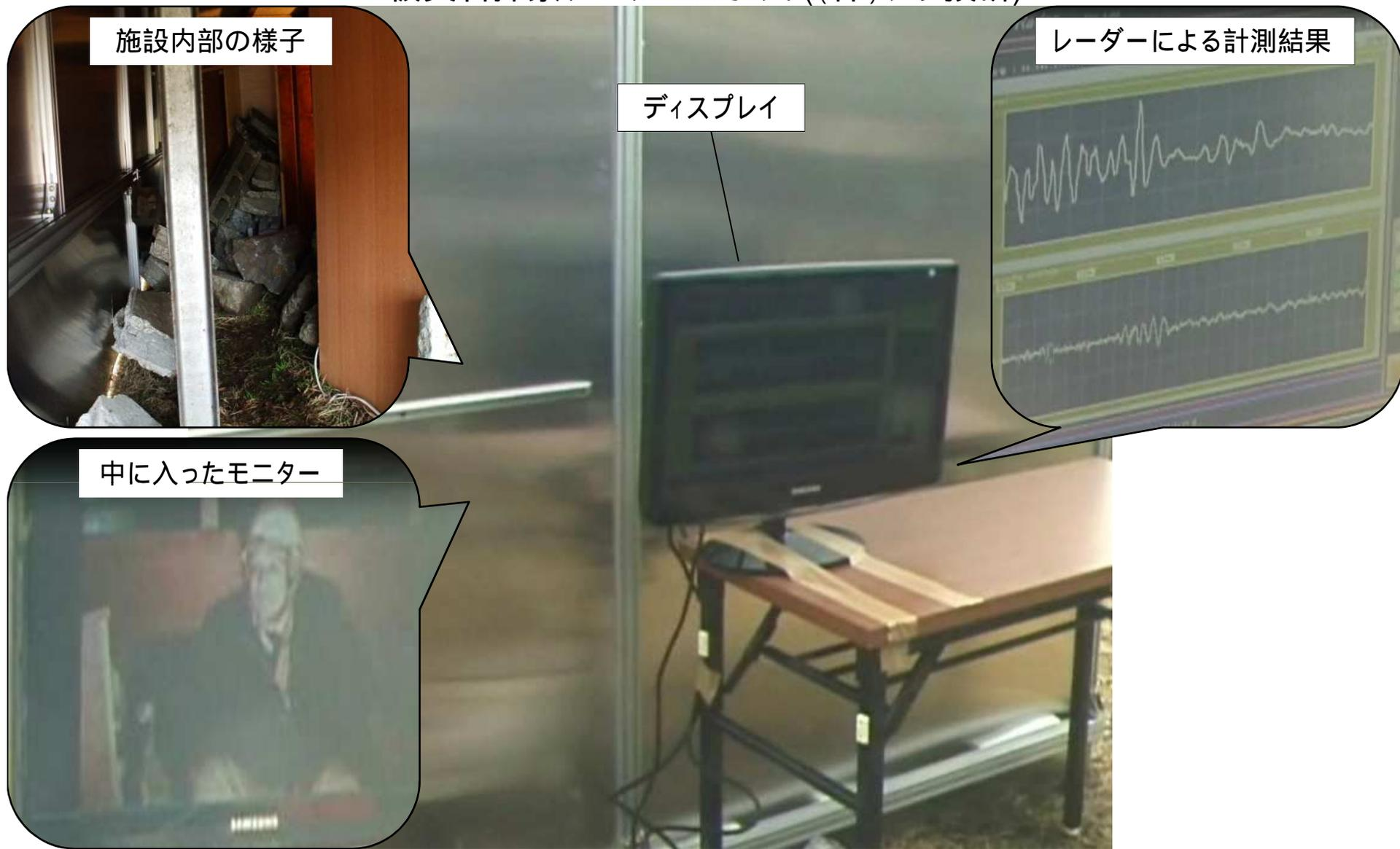
模擬瓦礫施設の一部を電波シールド材（アルミ板等）等で覆い、その中にモニターが入り、呼吸の検出とモニターまでの距離計測実験を行い、ロボットのレーダー部分の機能検証を行っている様子
