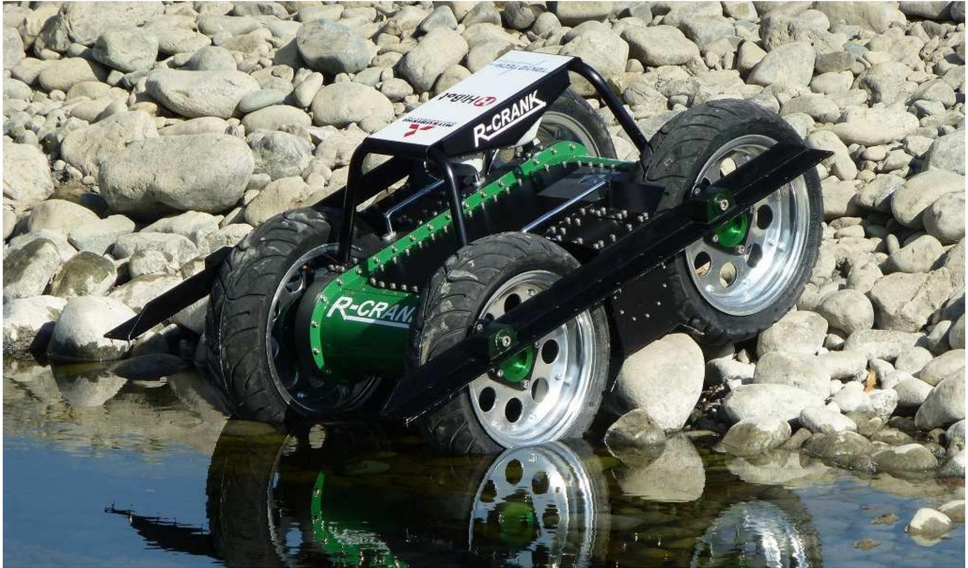
泥濘地・土砂災害現場を想定したエリア(水中、非整地のコース)において走行機構の性能を検証する実験を行い、新たなクランクレッグ走行機構の性能を検証している様子
