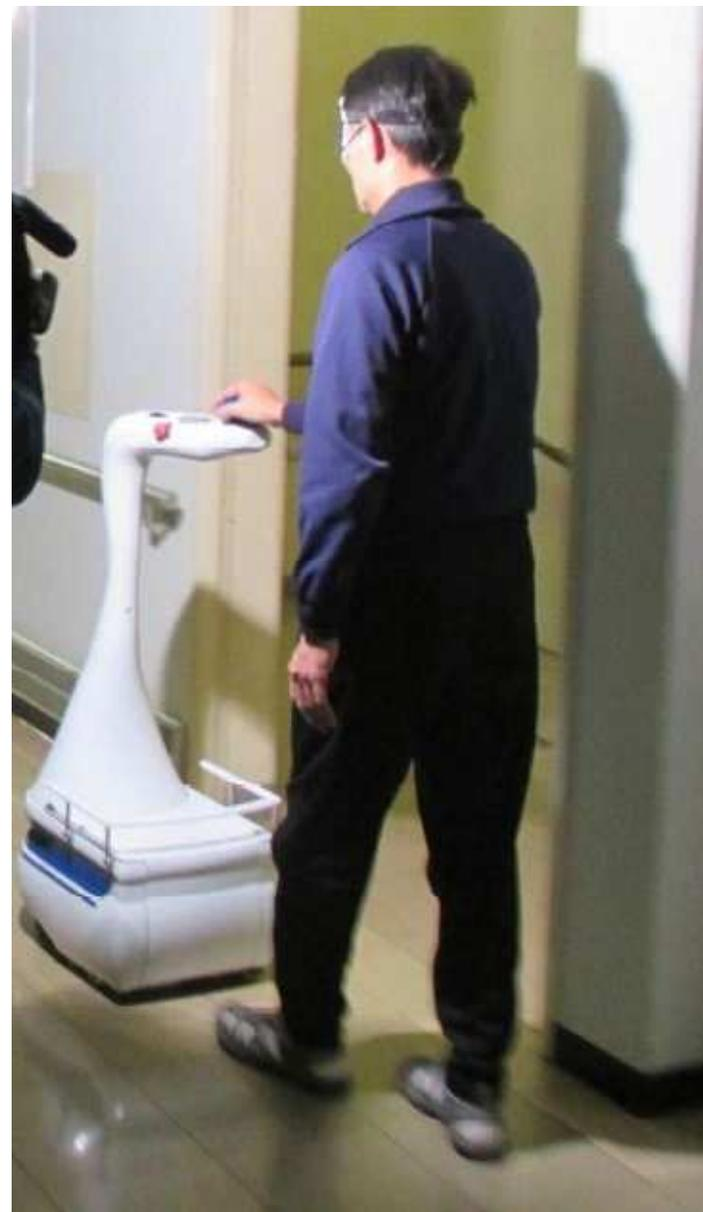
病院の施設内において、ロボットを使用してもらい、障害物回避、施設情報提供といったガイダンス機能を検証している様子
