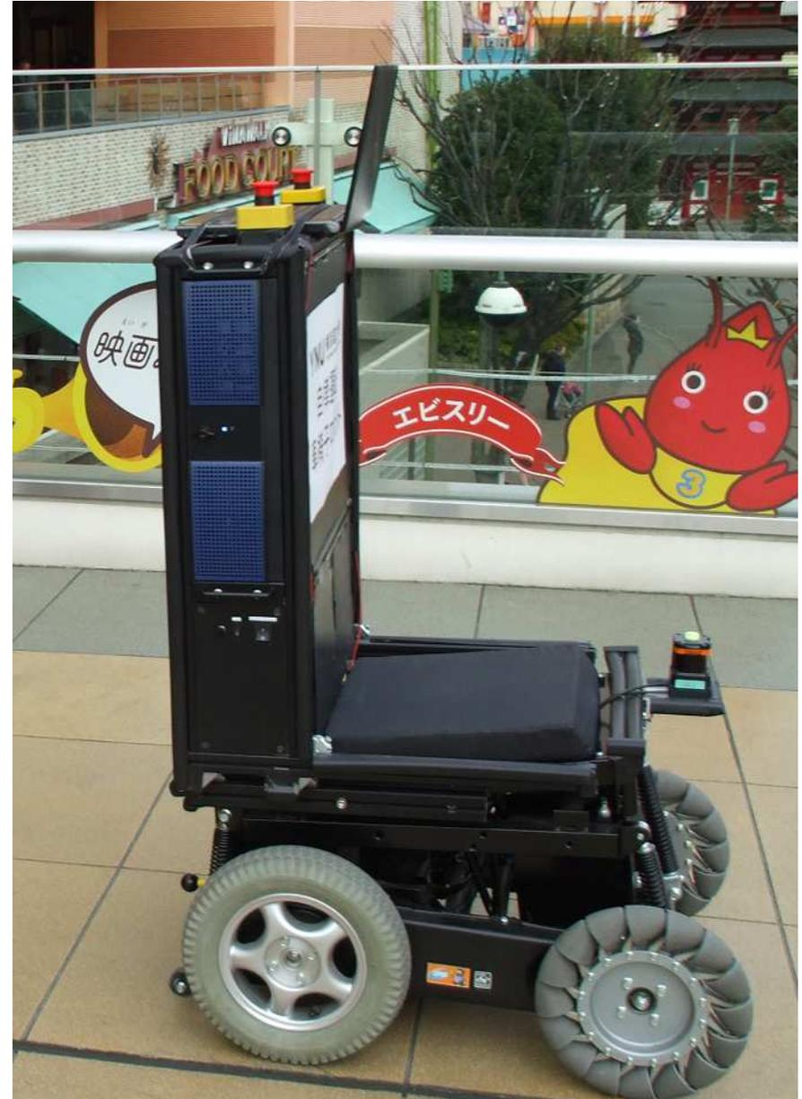
公道（横断歩道を含む歩道。左写真）と、大型商業施設（右写真）において、自律運転車椅子の運動性能などを検証する自律走行実験を行っている様子
