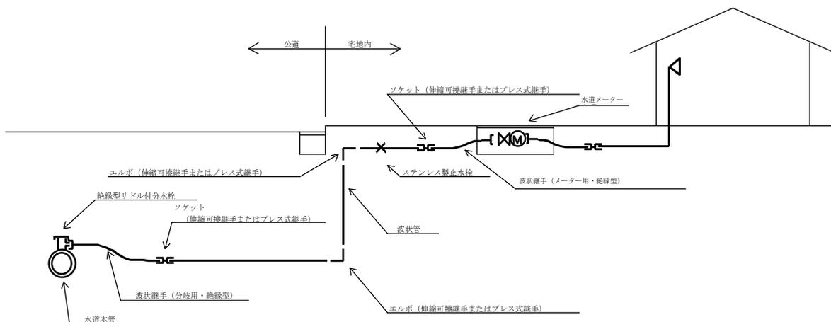
図5-6-2 標準配管例 (φ50 mm)
