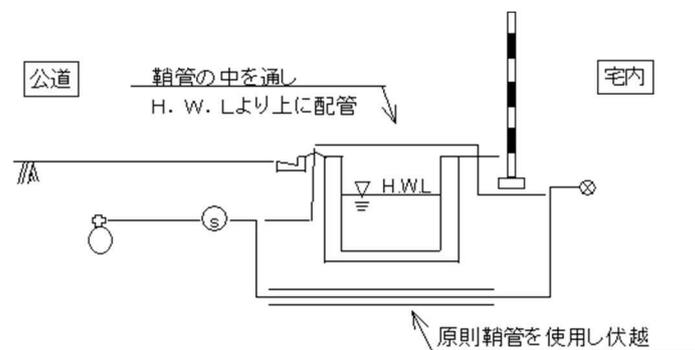
8について； L型側溝やU型側溝等構造物に支障を与えないようにするため。
