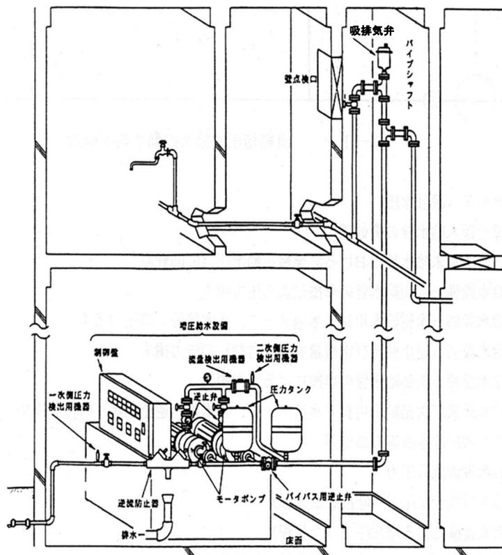
図 3-7-4 直結増圧給水の動水勾配線図
