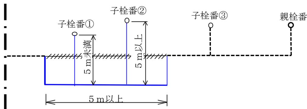
(例) 連合管を 5m 以上切回しする改造工事の場合
