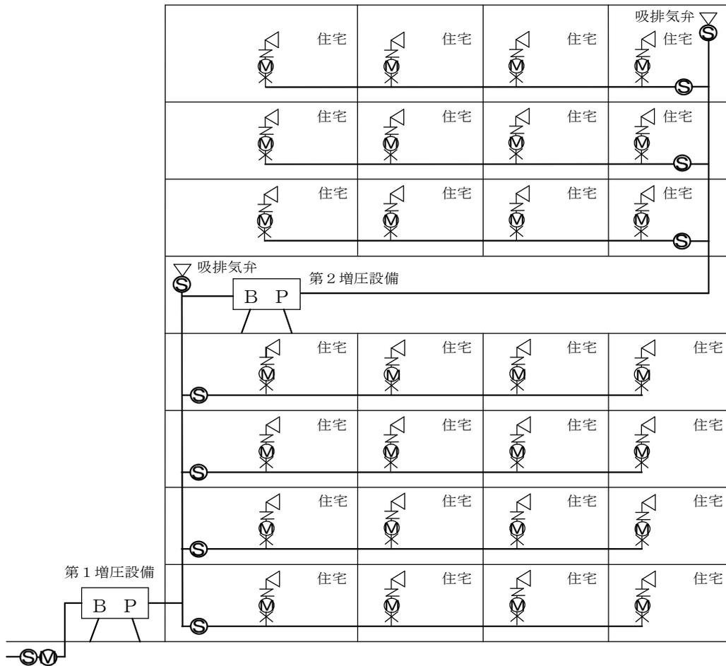
図 3-7-7 直結増圧式給水装置記号凡例
