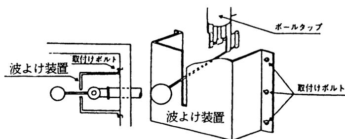
5について； 定水位弁は、小口径のボールタップまたは電磁弁を副弁として取付け、主弁を開閉するもので、主弁を受水槽の外に設置できるほか、ウォーターハンマーを防止することができる。
