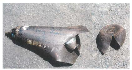
図1 破裂した酸素ガス容器の外観
