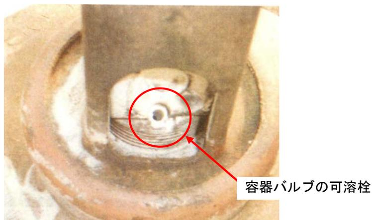
図2 溶解アセチレン容器バルブの可溶栓作動後の状況
