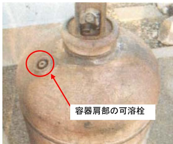
図1 溶解アセチレン容器肩部の可溶栓作動後の状況
