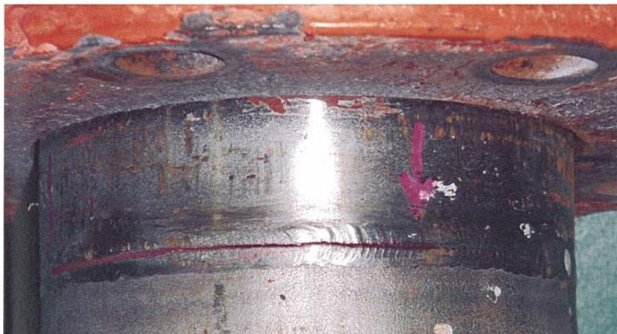
図 2 割れ部分の拡大写真
