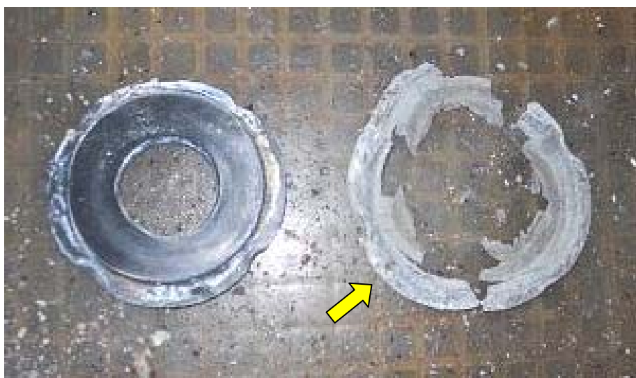
図3 PTFE製のパッキン(左)と腐食損傷したニトリルゴム製のパッキン(右)
