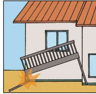
バルコニーの傾斜、破損
