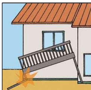
バルコニーの傾斜、破損
