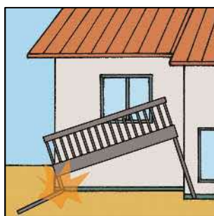
バルコニーの傾斜、破損
