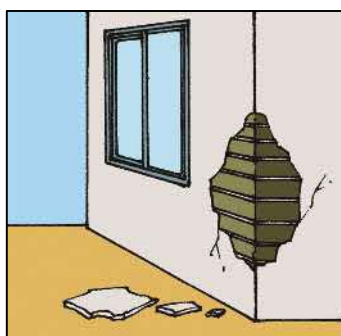
外壁の仕上材が剥落、腐朽又は破損し、下地が露出している
