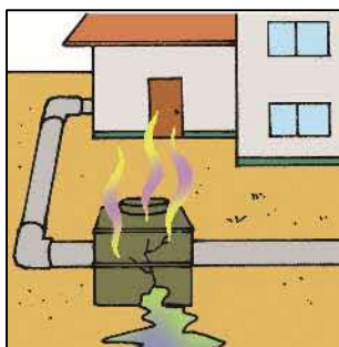
浄化槽等の放置、破損等による汚物の流出、臭気発生
