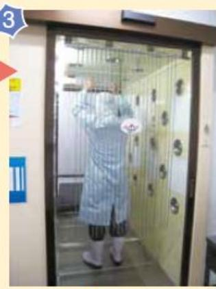
作業着のローラー掛けのあと、さらに、エアシャワー室を通り抜けて、体に付いた異物を吹き飛ばしています。
