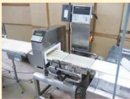
金属検出機は毎日作業前と作業後に、機械が正しく作動するか確認をしています。
