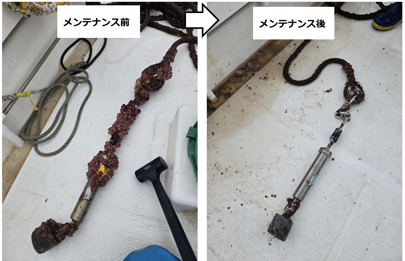
図2 流速計のメンテナンス
