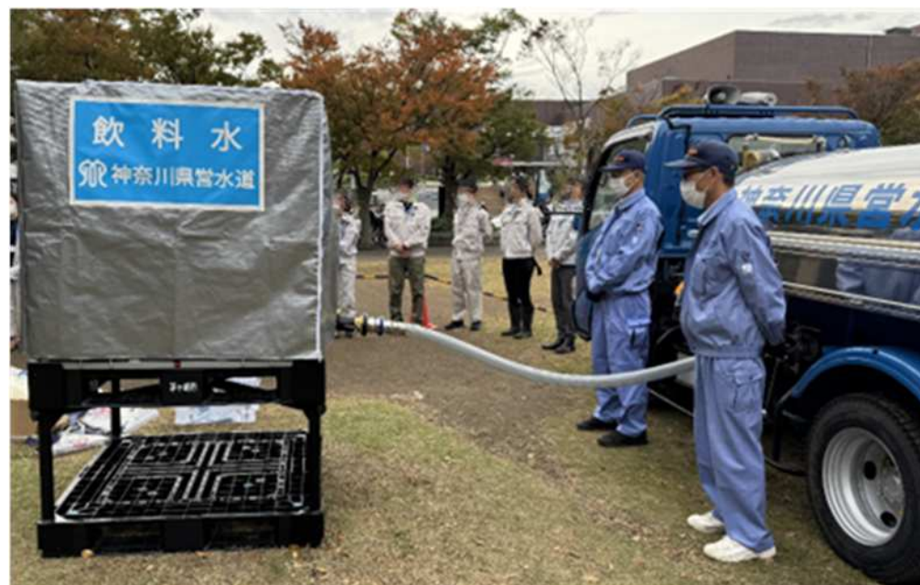
加圧給水車及び仮設水槽
